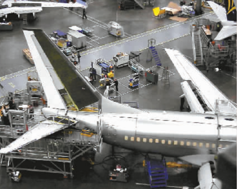
由中国制造的新一代波音737尾翼在美国西雅图波音737飞机组装厂组装。737飞机尾翼包共5000多个零件,分别由上海、西安和沈阳三个飞机制造厂生产。(本版照片均由新华社发)
