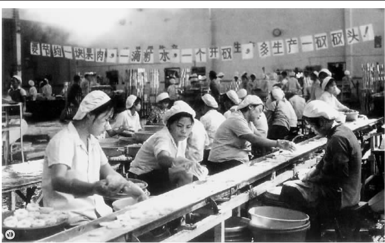
1970年海口罐头厂生产场面:①将菠萝送上输送带 ②收集菠萝 ③将菠萝装罐
