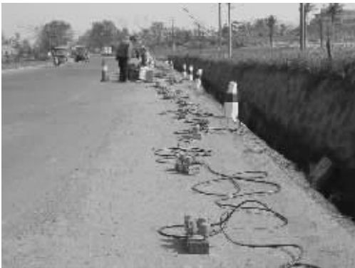
海口市活断层探测项目浅层人工地震勘测工作现场
