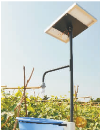
2月23日,安装在田洋里的太阳能杀虫灯正在充电。 本报记者 苏建强 摄
