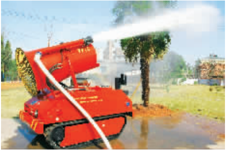
3月17日,消防机器人在进行射水测试。当日,一台价值80余万元的消防排烟机器人正式装备安徽淮北消防部队。该机器人具有灭火喷射、排烟降尘、实时探查等功能,可原地转向、爬40度坡和在150米内无线遥控作业。 新华社发(万善朝 摄)
