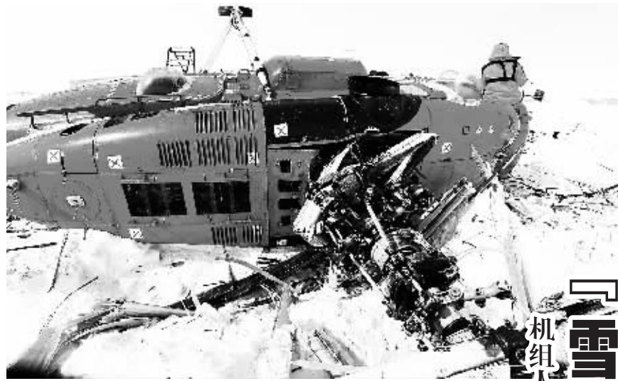
“雪鹰”KA32 直升机迫降后右侧着地,螺旋桨已摔得粉碎,裸露出轴承部位。 新华社记者 黄小希 摄
