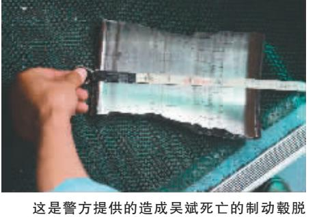
这是警方提供的造成吴斌死亡的制动毂脱落残片照片。
