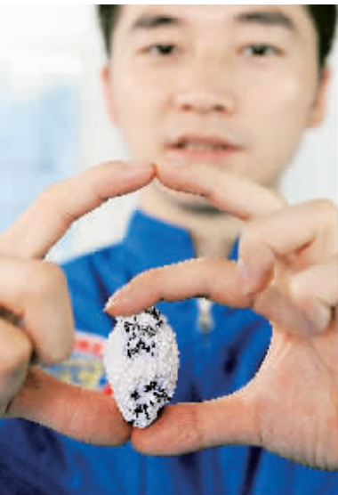
7月16日,深潜员付文韬在展示一个原本直径15厘米的泡沫实验球被水压压缩后的形态。
