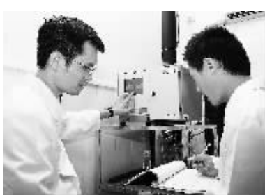
工作人员通过PM2.5自动监测仪对该站点的PM2.5开展监测。
