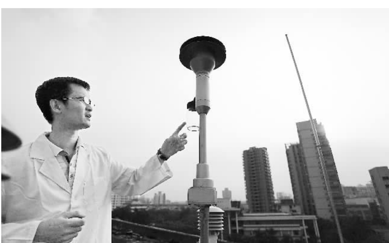
9月18日,在海南师范大学子站,工作人员通过PM2.5采样头把周边空气采集到滤膜。
