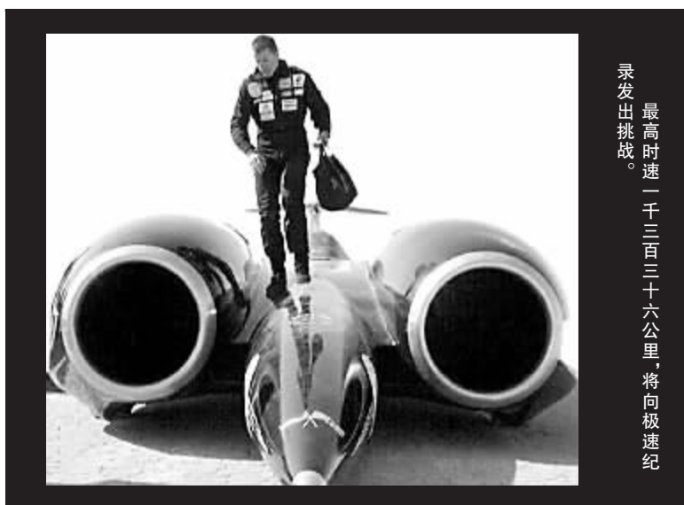
最高时速一千三百三十六公里,将向极速纪录发出挑战。 极速“北美鹰” “北美鹰”长约17米,采用喷气式发动机,主体酷似战斗机座舱。 《星期日泰晤士报》说,“北美鹰”的最高时速预计达到1336公里。由于橡胶轮胎无法承受汽车高速行驶时产生的巨大热量,“北美鹰”选用了铝制车轮。此外,“北美鹰”还配有电磁制动设备和两个约2.4米宽的减速带,以便高速行驶后快速刹车。 沙德尔说,“北美鹰”能在20秒内由静止加速到1280公里;4.5秒行驶完1.6公里路程;全速行驶时,每分钟消耗
