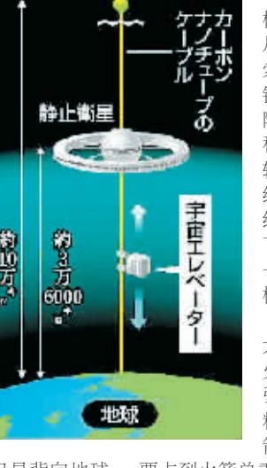
固的材料做缆索,都有可能承受不了“太空电梯”的重量而发生断裂。从理论上计算,制作缆索的材料强度必须达到钢铁的约180倍。但是,随着纳米技术的发展,科学家不断开发出质量轻、强度高的碳纳米管纤维材料,现有的此类纤维材料强度已经达到了所需强度的约四分之一,这使修建“太空电梯”逐渐成为可能。
