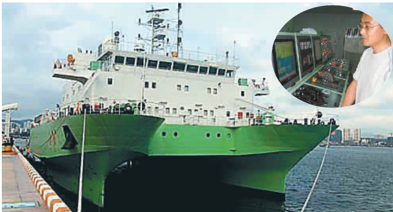
大图:我国最先进的科学考察船之一“实验1”号日前在三亚完成首航。它是中国第一艘2000吨级以上大型小水线面(船体与水面接触面积很小)双体船,也是中国第一艘小水线面综合科考船。“实验1”号船
