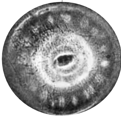
西汉“见日之光”青铜镜(透光镜)反射光图像。
