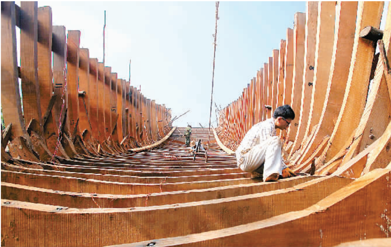
临高县调楼村的海南荣升造船厂正在建造百吨深海捕鱼船。本报记者 苏晓杰 摄
