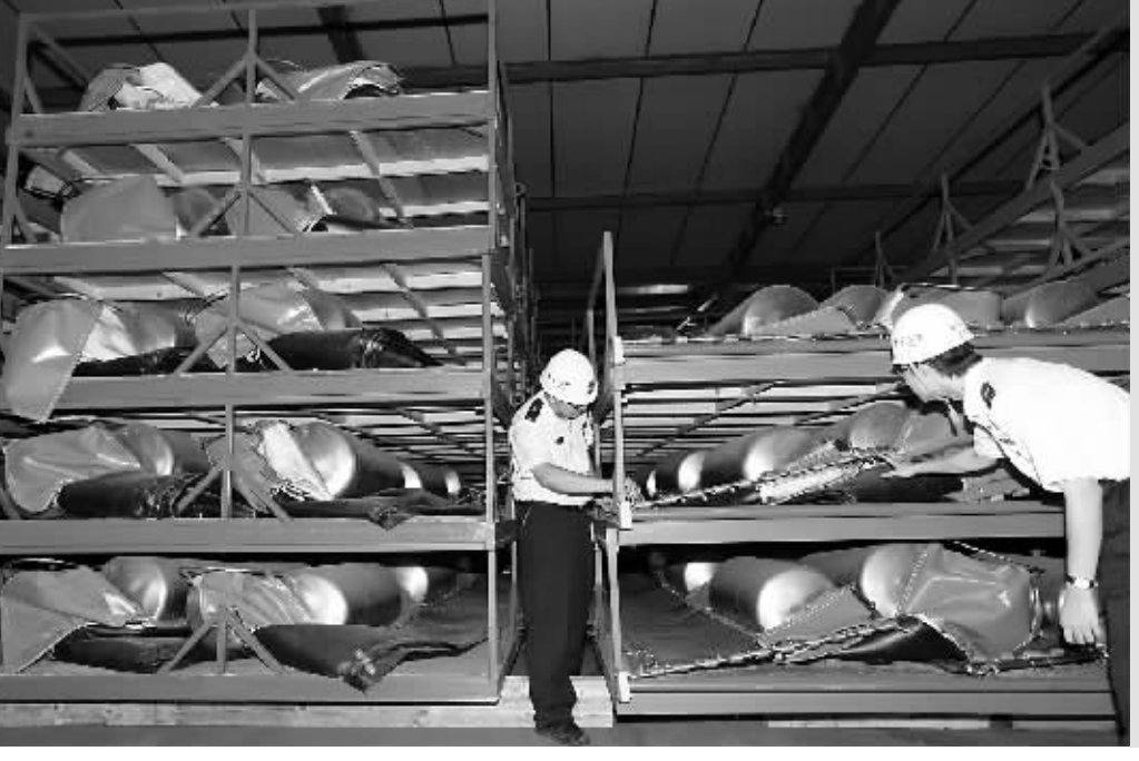
洋浦海事局 维护保养溢油设备
