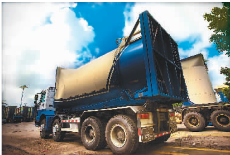
海口的市区垃圾经过分类压缩后,用垃圾储运罐运送到终端处理。 本报记者 李幸瑛 摄
