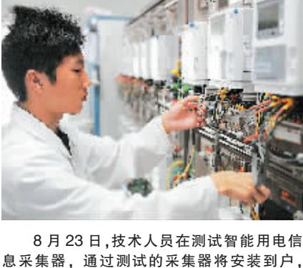
8月23日，技术人员在测试智能用电信息采集器，通过测试的采集器将安装到户，实现用电信息远程自动采集等多种功能。
