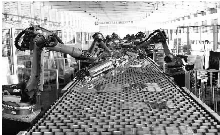
11月28日，海南中航特玻生产基地1号电子玻璃生产线上，“机械手”正在搬运成品的玻璃。 本报记者 宋国强 摄
