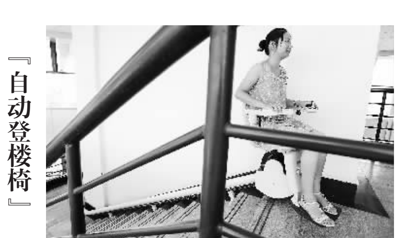
7月22日，一名工作人员坐在“自动登楼椅”样机上进行演示。在没有电梯的小区里，老年人每天上下楼很不方便。浙江大学城市学院电信、工程、创意、计算等分院的科研人员为此联合研制了“自动登楼椅”，帮助老年人解决“爬楼难”问题。据介绍，“自动登楼椅”系统的安装成本约为每层1至2万元，批量生产后价格将更低，日常维护也较简单。
