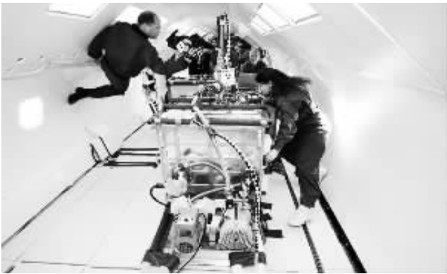
美国宇航局正在太空飞行的低重力环境下测试 3D 打印机。
