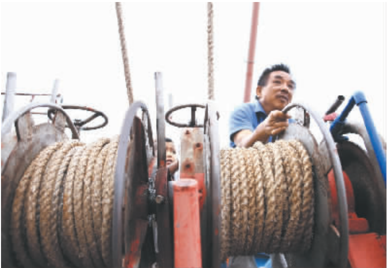
在黄家轻的渔船上,渔民用机械齿轮拉网。用机械齿轮代替人力拉网,更加安全高效。
