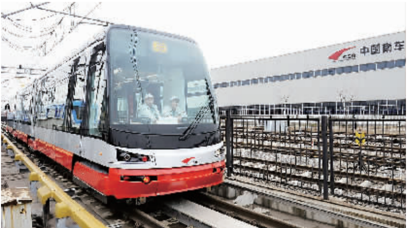
2月17日,新一代永磁有轨电车在测试线上运行。当日,国际目前最先进的第三代100%有轨电车样车在中国南车四方股份公司下线,该车辆在国内外首次采用永磁电机驱动、铰接转向架两项世界领先技术,具有高效安全、低噪环保、运营维护成本低、曲线通过能力强的技术特性。该车辆的最高运行时速70公里,采用三节编组时总载客量超过300人。 新华社记者 李紫恒 摄
