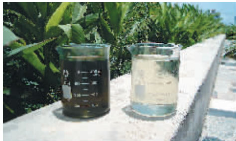
文昌市文教镇人工湿地污水处理系统,净化前后的生活污水对比明显。省环科院供图
