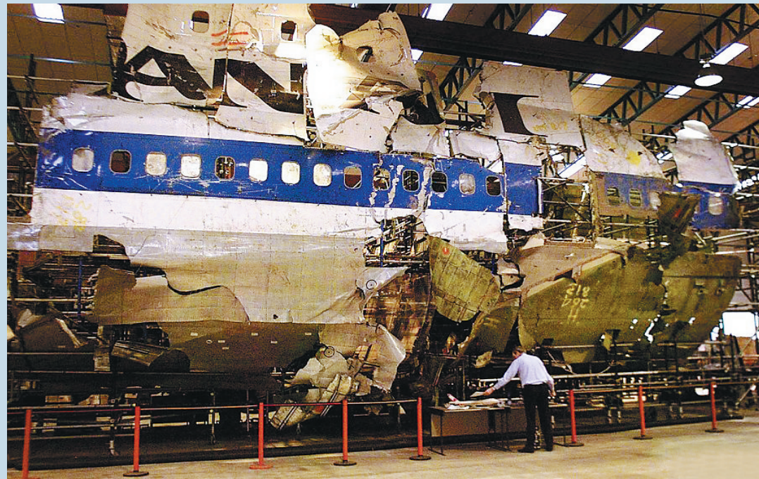
AAIB的实验室内,工作人员正在用空难现场取得的无数块碎片重新拼装这架巨大的飞机。
