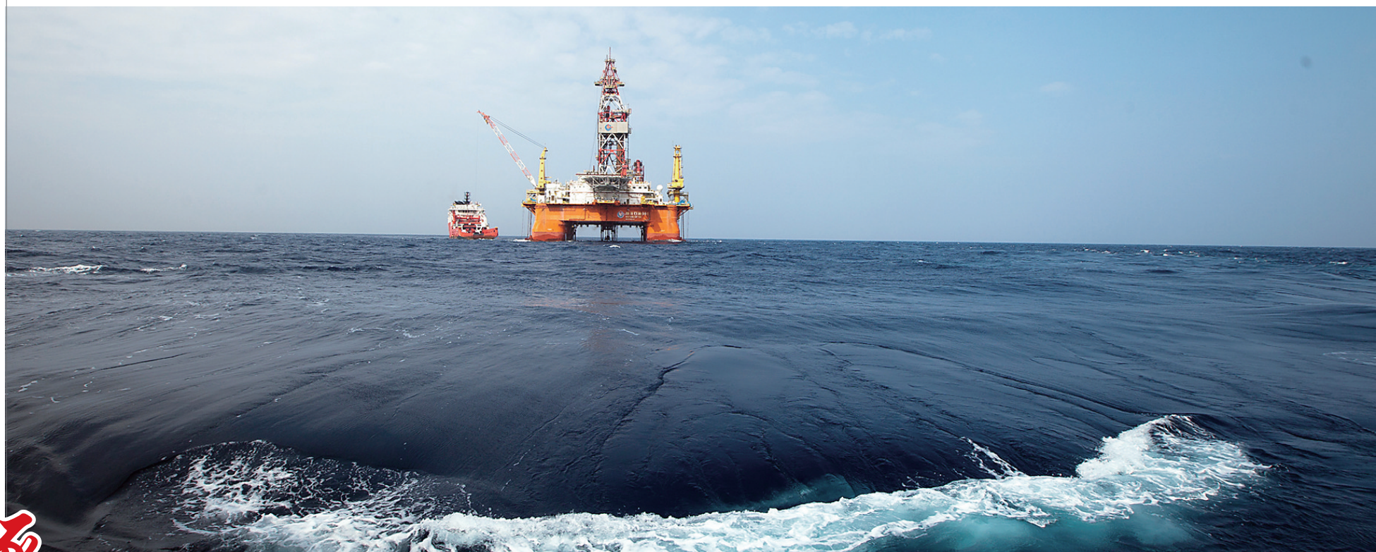
海洋石油981是专门为南海深水打井而设计，其特有的动力定位系统能够抵抗南海巨大的内波流。中国海洋石油报 赵亮 摄
