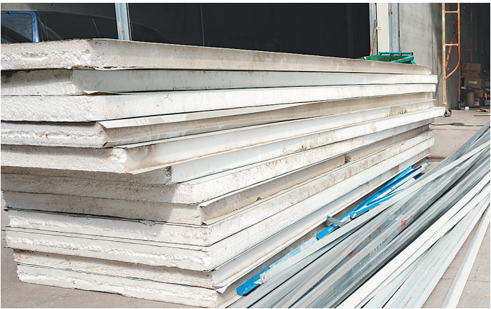
三亚永晋汽车城进行消防整改时拆下的建筑材料,其夹层聚氨酯泡沫保温材料,燃烧速度快且会产生剧毒氰化氢气体。
