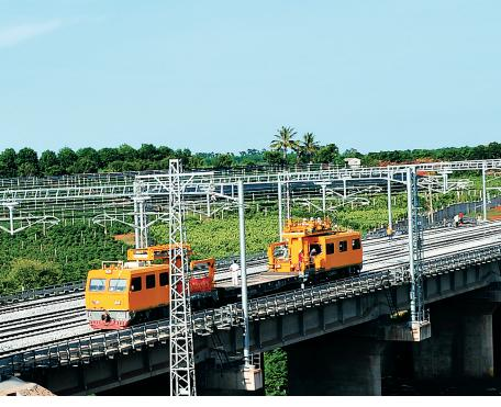
西环铁启动“冷热滑”检测
