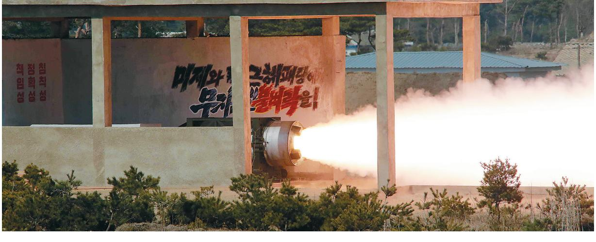
→ 朝中社3月24日提供的照片显示,朝鲜进行大推力固体火箭发动机地上点火试验和多级火箭箭体分离试验。新华社/朝中社
