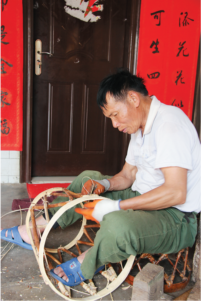
林亚遵在制作牛皮凳的主体框架——用细藤条将粗藤条和上下两个圆木框连接起来。 陈耿 摄
