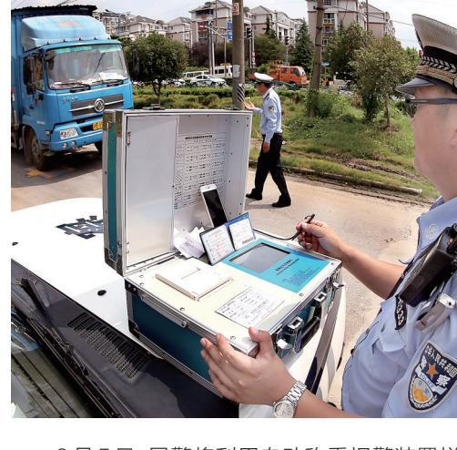
8月5日，民警将利用自动称重报警装置拦截的超载货车进行精确称重。
