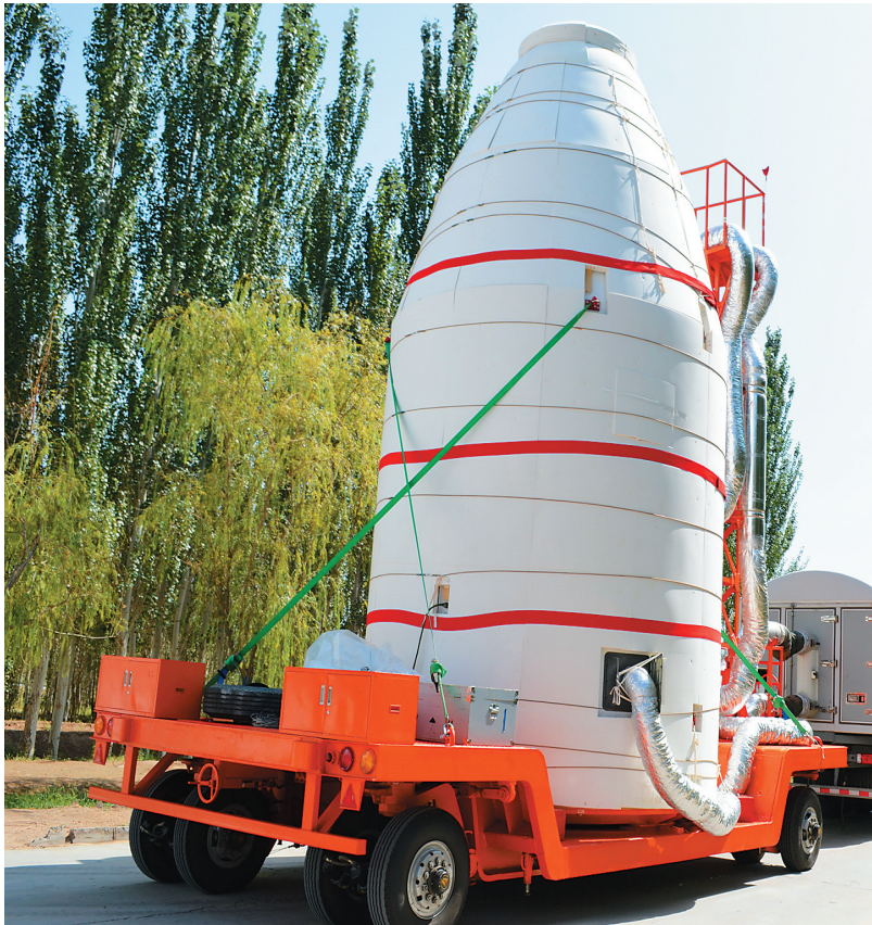
在酒泉卫星发射中心,星罩组合体在转运至发射塔架。
