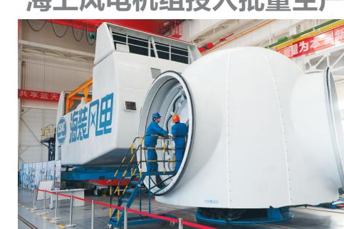
12月9日，中船重工江苏海装风电设备有限公司员工正在组装风机轮毂。
