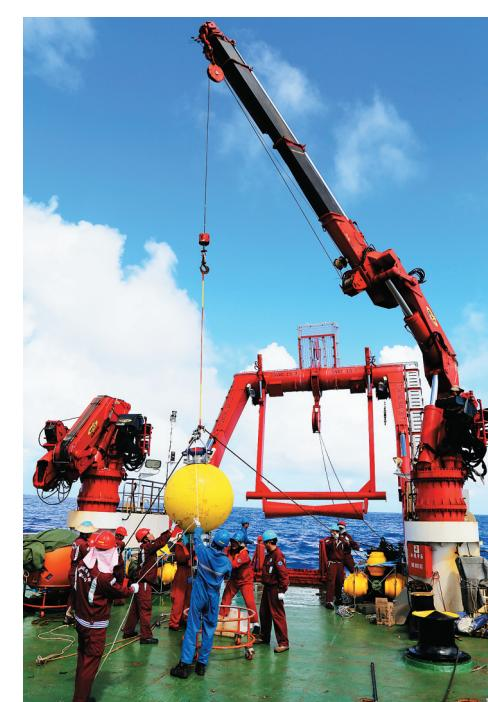
科考队员正在进行深海潜标主浮球和声学多普勒流速剖面仪的回收。新华社发
