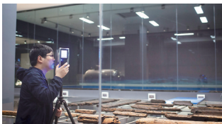
利用三维激光扫描仪可采集出水船板数据。
