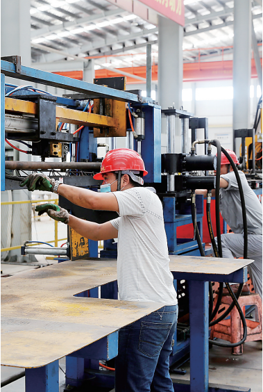
↑ 6月21日，两名技术工人正在构件工厂检修YTG12钢筋桁架焊接生产线。
