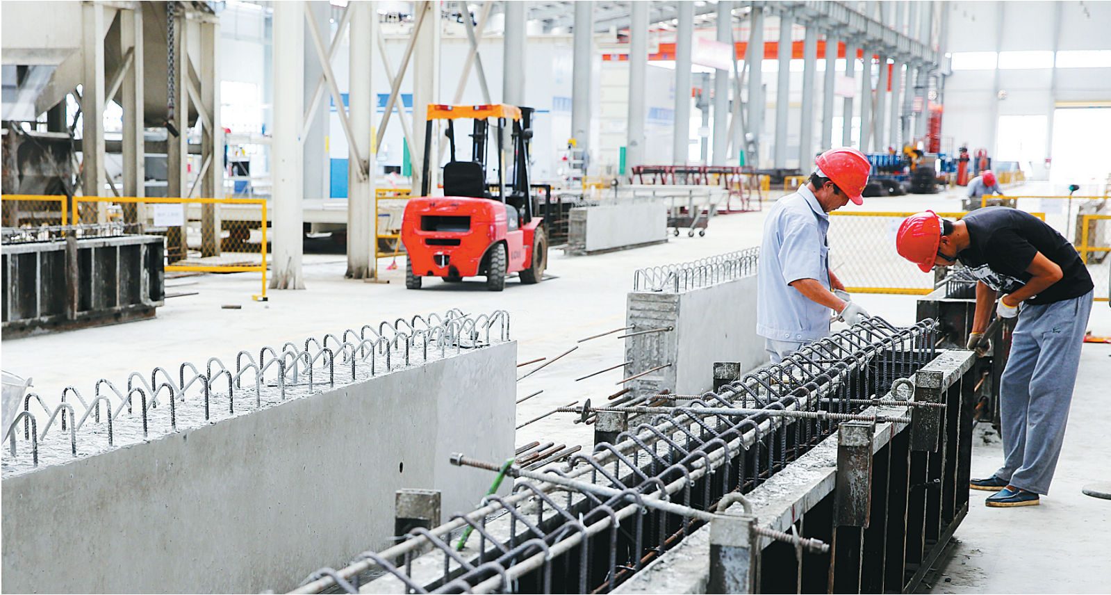
↑ 6月21日，两名技术工人正在构件工厂检修YTG12钢筋桁架焊接生产线。
