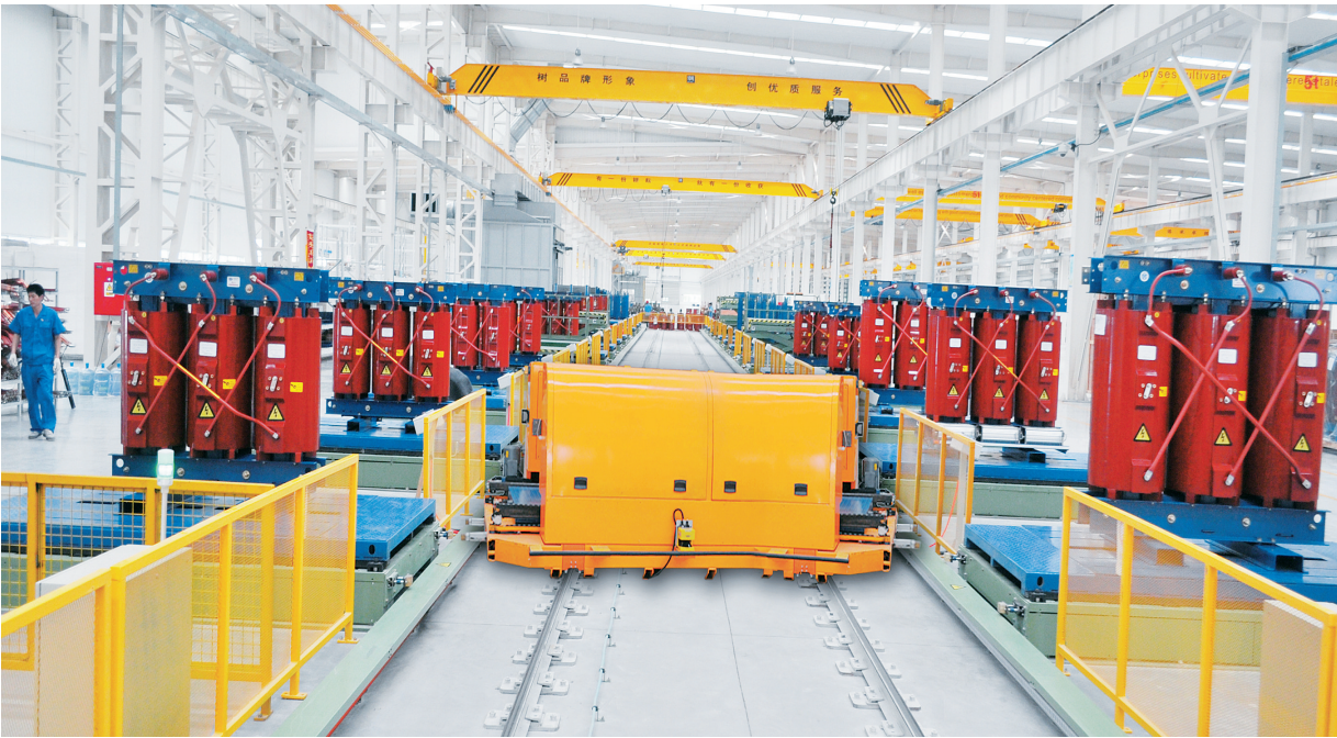
金盘电器变压器总装生产线。省工信厅供图
