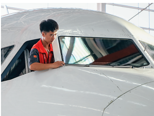
飞机在维修时,驾驶舱滑动侧窗可以打开。滑动侧窗在空中是不允许操作的。
