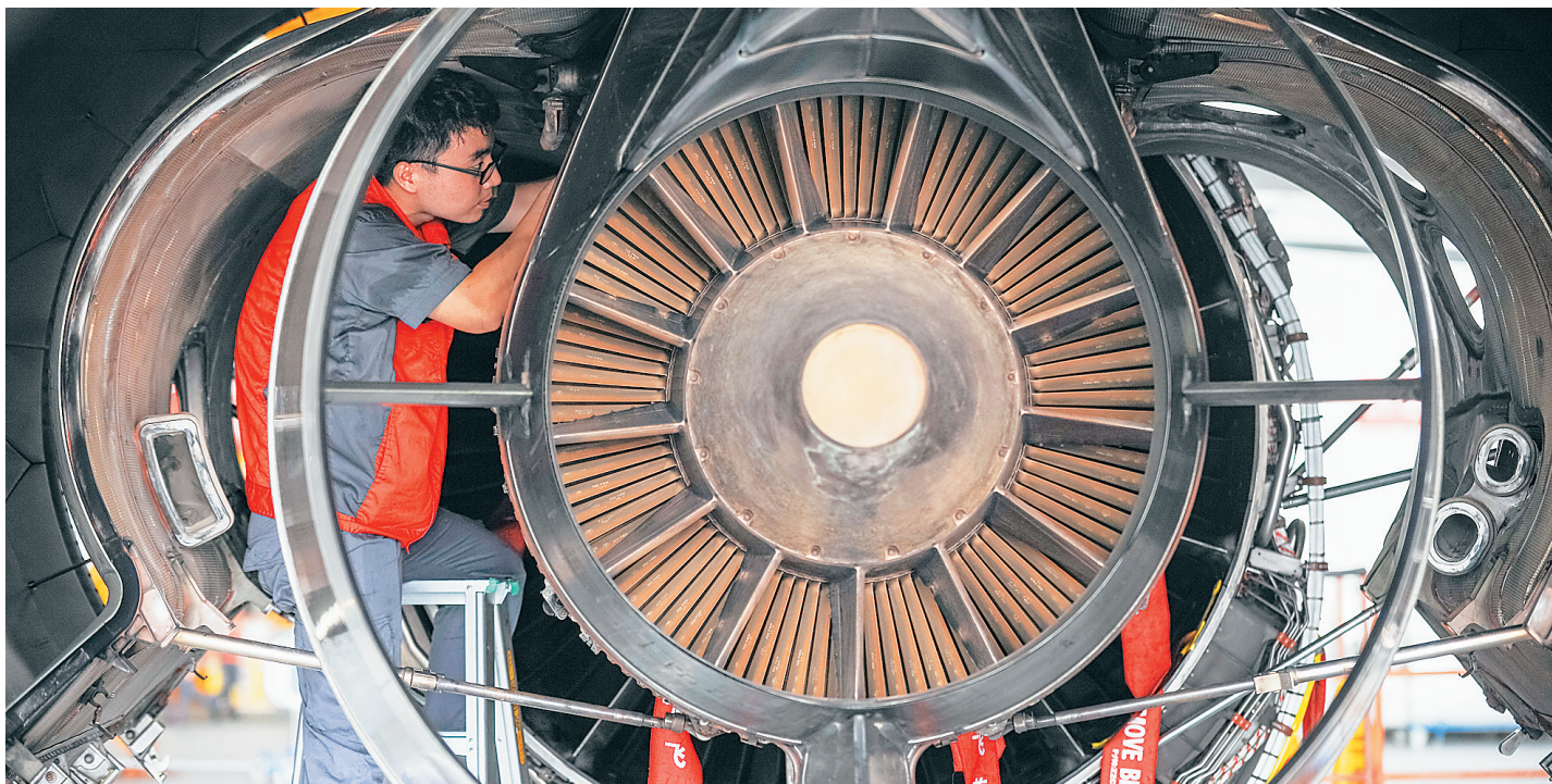
工作人员正在对飞机发动机进行探伤检查。对于飞机的「心脏」——发动机,要检查其所有附件、管路及导线是否有磨损,液压管路是否正常。
