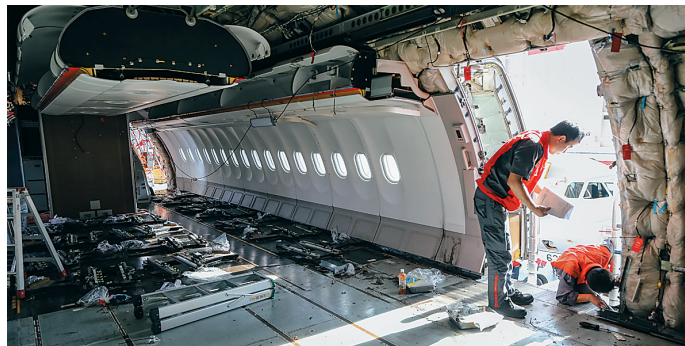
机舱内部的座椅全部拆除,要进行彻底的维修和清洁。
