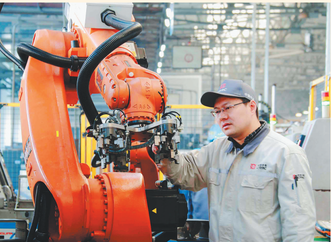
“技改大王”、中国中车威墅堰机车车辆工艺研究所有限公司首席技师刘云清在改进首条机器人涡轮壳生产线的机器人夹具。
