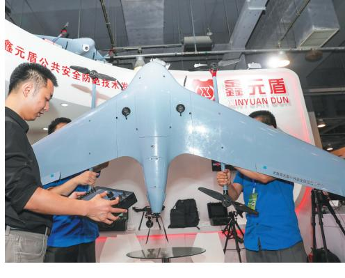
5月15日,在北京鑫元盾公共安全防范技术发展中心展台,工作人员在演示鑫元盾GAWRJGD0008XYDV型复合翼无人机操作。这种无人机续航时间96分钟,控制半径30公里,最大速度120公里每小时,可在中雨条件下飞行。
