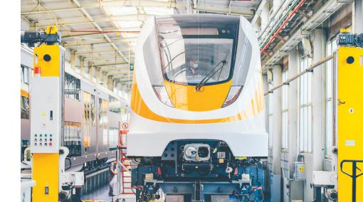
4月29日，中车长客股份公司职工对新型中低速磁浮列车进行调试整备工作。
