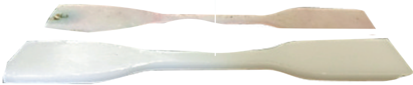
在海水里浸泡3个月的海水可降解塑料样品(上)和良好保存的样品(下)对比。(本版照片除资料图外由受访者提供)
