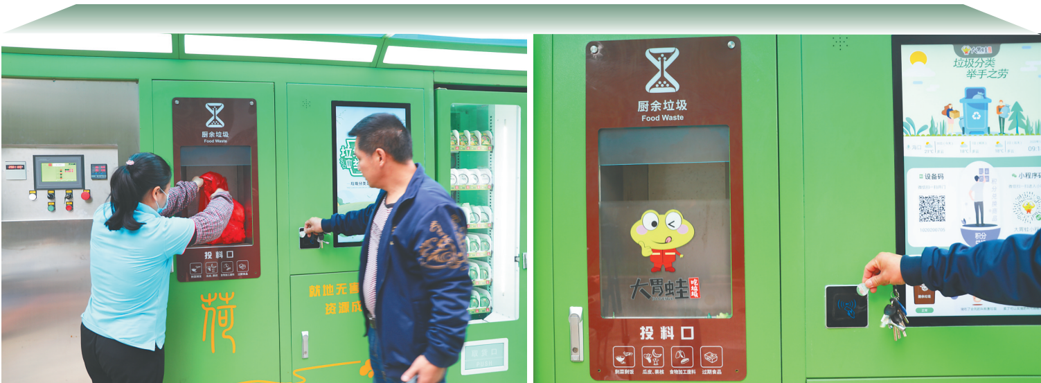
左图:小区居民刷卡后,降解机的面板自动打开,把厨余垃圾“吃”进去。右图:海悦东方小区引进的智能餐厨垃圾降解机。
