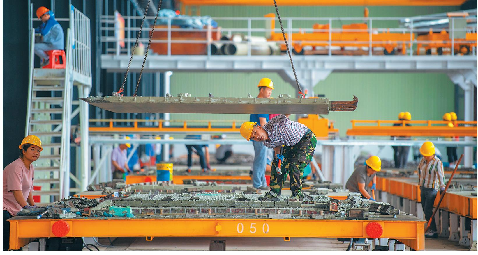
3月9日，位于万宁礼纪镇工业区的海建（万宁）建筑产业化基地，工人在生产车间内赶制钢筋混凝土预制构件订单。据了解，该基地业务能填补目前海南东南部区域装配式建筑发展的产能缺口。目前，该基地各条生产线正满负荷运行。
