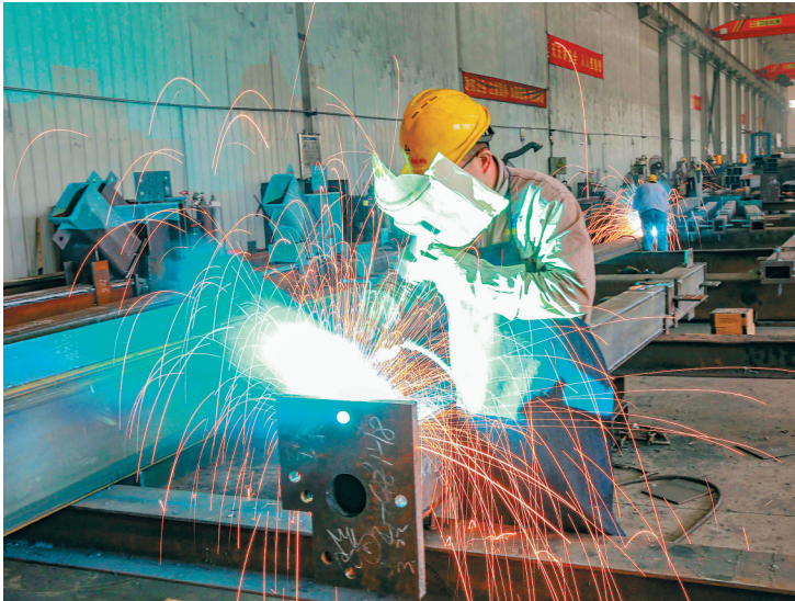
位于海南老城经济开发区的海南省建筑产业化股份有限公司装配式建筑产业工厂里，工人正在加工钢结构建筑的梁和柱。
