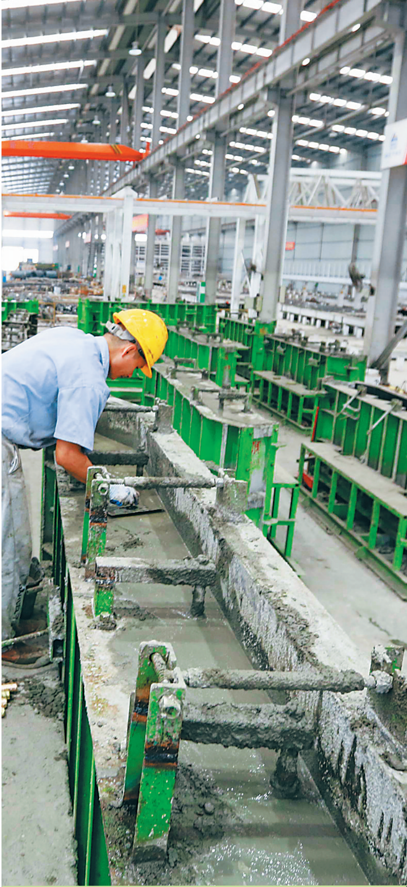
工人在楼梯模型里浇筑水泥，生产楼梯。
