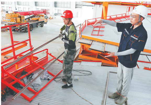
↑机械工程师杨元正(右一)指导工人安装可伸缩的护栏。
