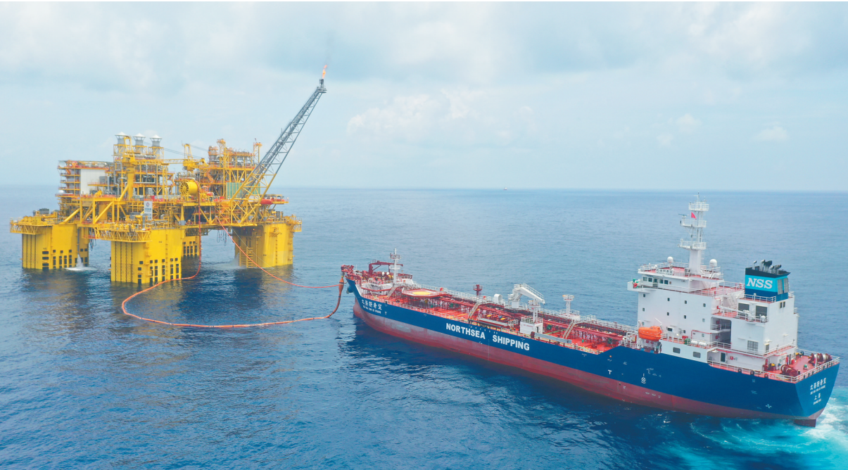
「深海一号」能源站通过动力定位系统与牵引绳定位油轮北海新希望号。
