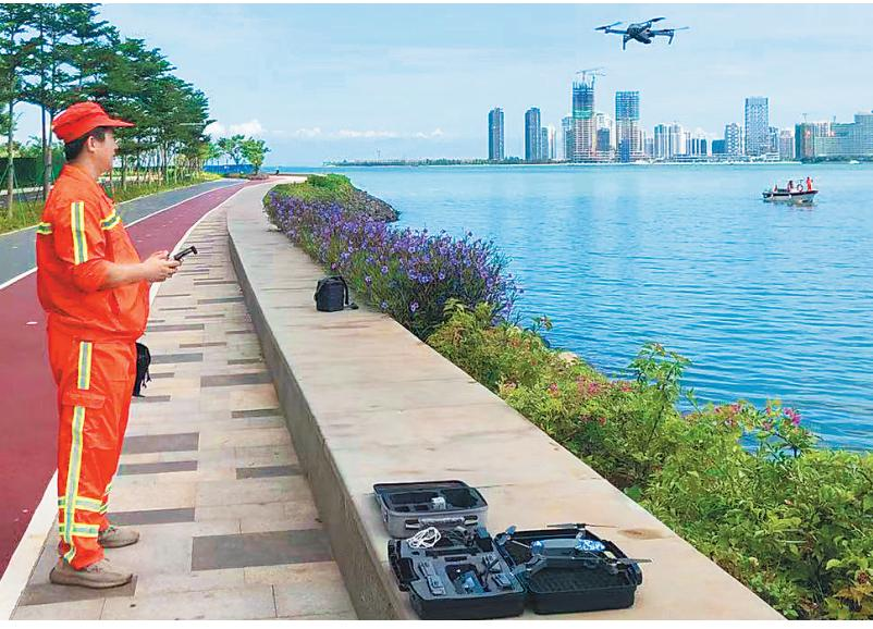
龙马环卫公司操作员正操控无人机引导机械环卫船打捞海上漂浮物。
