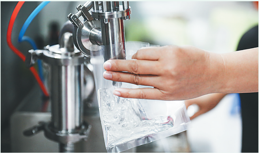
中国热科院橡胶研究所的实验员用机器定量分装植物生长培养基,为组培橡胶苗做准备。
