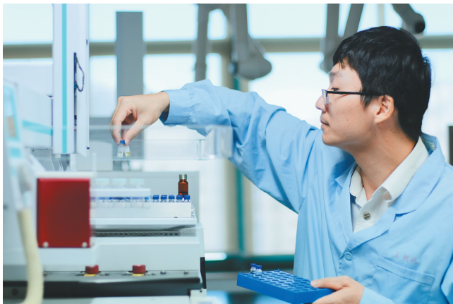
在海口海关技术中心，技术人员正在开展进境粮谷中有害农药残留检测。 本报记者 封烁 摄
