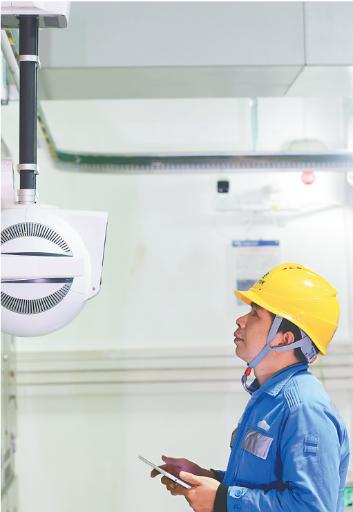
南方电网海南电网公司首座数字孪生变电站大英山站智能巡检机器人在巡检设备。 莫娟 摄
